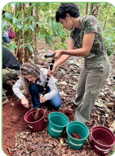
Figura 6: Curso de ILPF com foco em carbono. Prática de coleta de solo, realizada segundo as diretrizes do protocolo de carbono desenvolvido pela Câmara de Carbono da Rede ILPF. (Fonte: SustentAgro).
