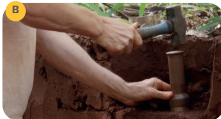
Figura 2: Anel acoplado ao castelinho (A) e empurrado ao solo com o auxílio de um martelo (B) para que o solo preencha totalmente o volume do anel
