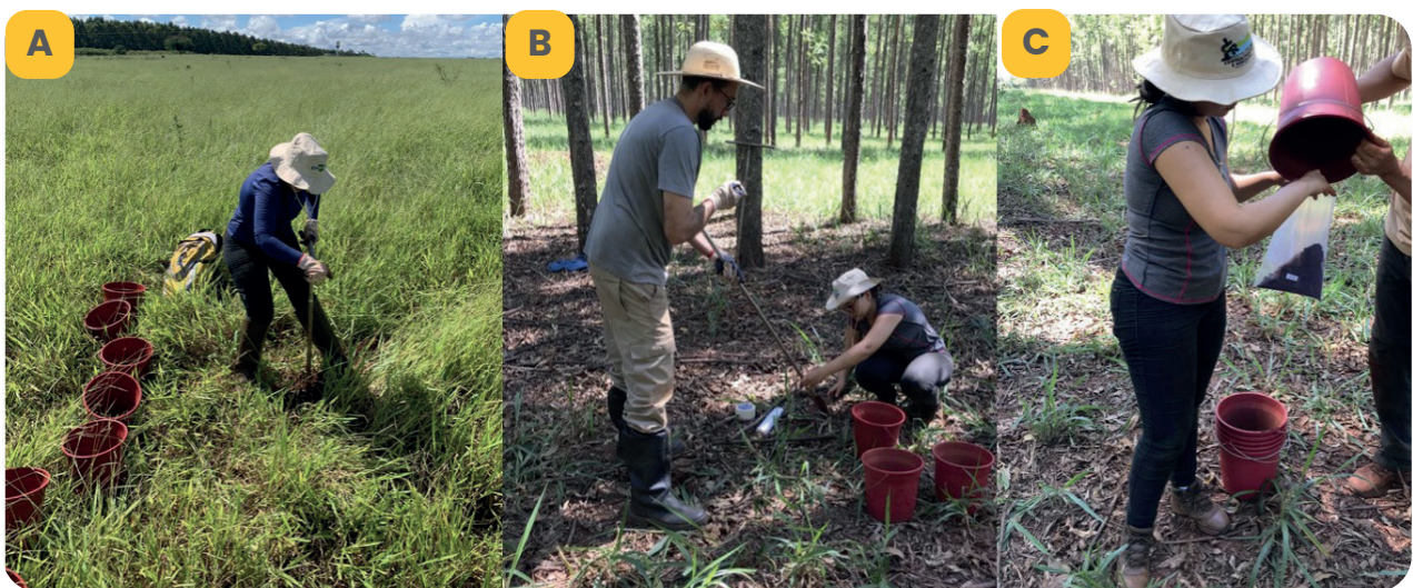
Figura 3: Etapas para coleta da amostra simples com trado ( A ), homogeneização para formação da amostra composta por profundidade ( B ) e armazenamento em sacos plásticos das amostras compostas ( C ).
