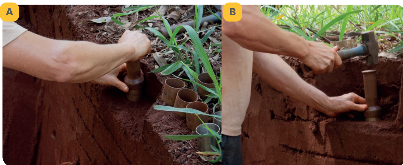
Figura 6: Anel acoplado ao castelinho (A) e empurrado ao solo com o auxílio de um martelo (B) para que o solo preencha totalmente o volume do anel.
