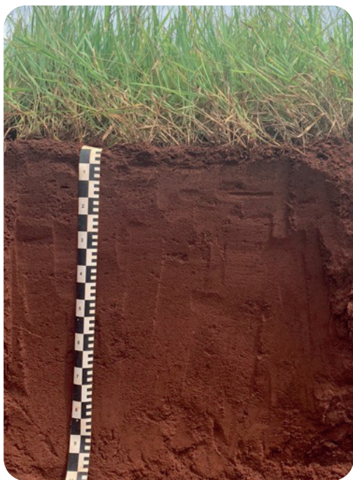
Figura 4: Trincheira com a fita métrica para delimitar as profundidades para amostragem
