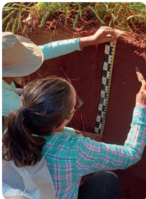
Figura 5: Demarcação das profundidades das amostras a serem coletadas nas trincheiras
